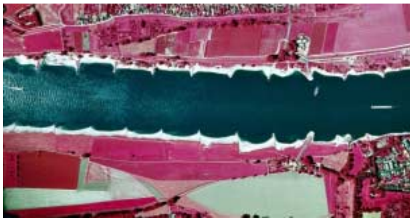
Aménagement d'épis à hauteur de Düsseldorf – Kaiserswerth (photo infrarouge)
