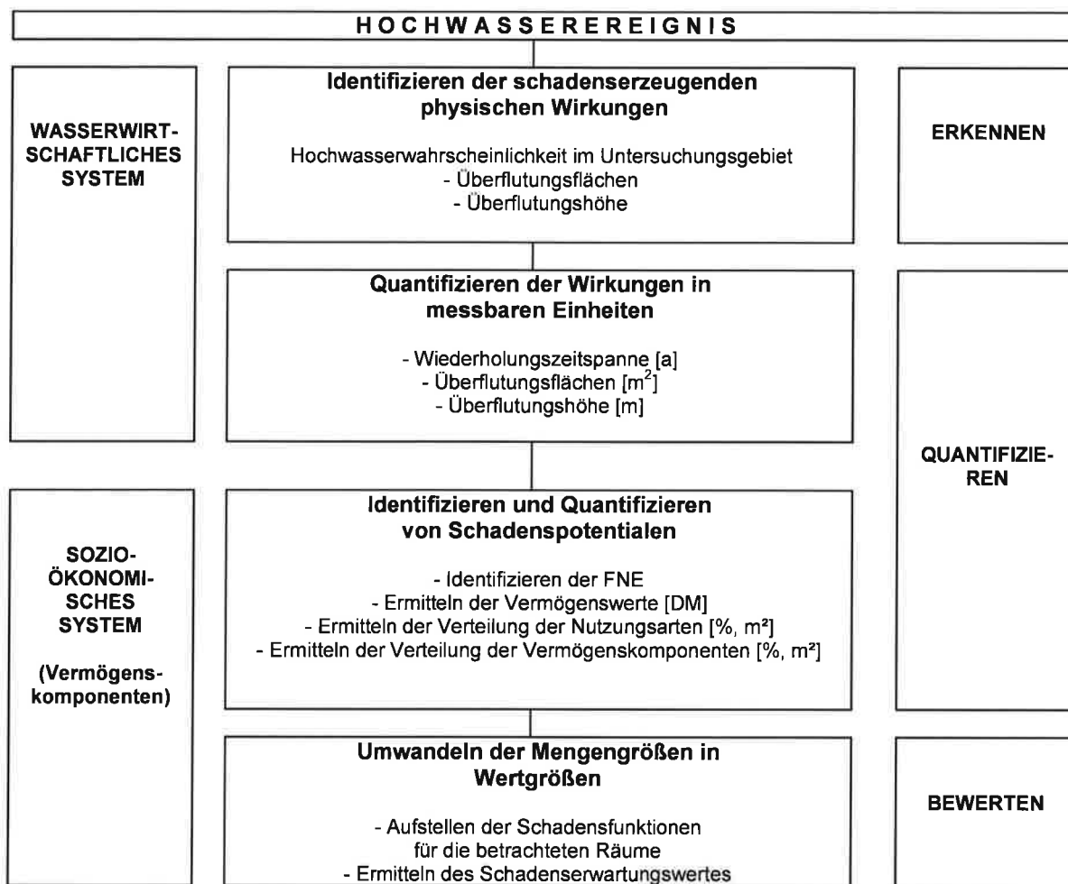
Bild 5.1: Grundlegende Verfahrensschritte zur analytischen Bewertung von Hochwasserwirkungen; in Anlehnung an Günther, W., Schmidtke, R.F., Klaus, J. Lindstadt, H.J., 1981
