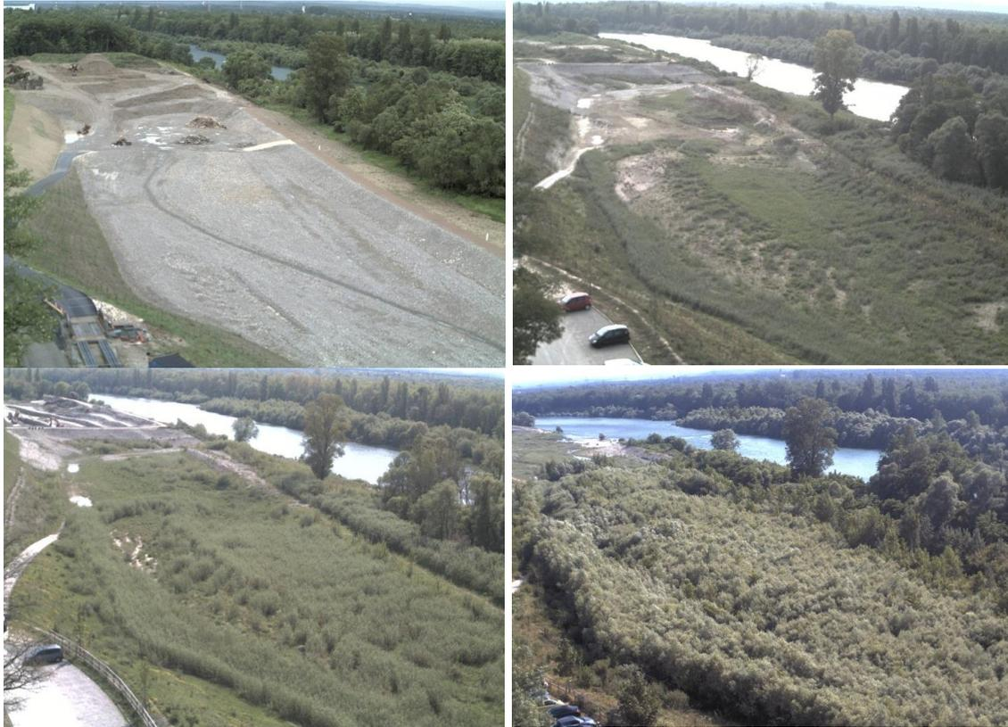
**Abbildung 7:** Rückhalteraum Weil-Breisach (Abschnitt I), Sukzession aus Pappel und Weide von 2012, 2014, 2016 und 2019 (von oben nach unten) nach Tieferlegung (Quelle: Regierungspräsidium Freiburg)
