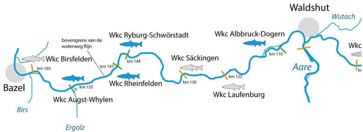
Figuur B2.4: Stuwen en situatie van vismigratievoorzieningen met betrekking tot de stroomopwaartse vismigratie in de Hoogrijn. Boven: van het Bodenmeer tot monding van de Wutach; onder: van de waterkrachtcentrale Rekingen tot Bazel. Met betrekking tot de stroomafwaartse vismigratie moeten alle installaties worden aangepast.
