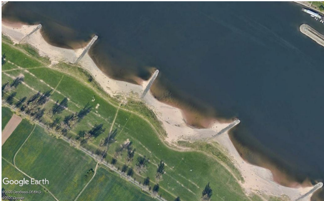
Figuur A2.5: Langs de Duitse Nederrijn wisselen oevers met steenblokken en kribvakken elkaar af. In de brede zone tussen de kribben met een fluctuerend waterpeil loopt het visbroed het risico om bij golfslag te stranden. Bron: GoogleEarth.
