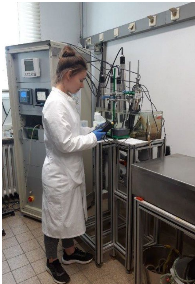
Foto 6: Kalibratie van sondes in het meetstation Koblenz-Rijn (BfG), Rijnland-Palts
